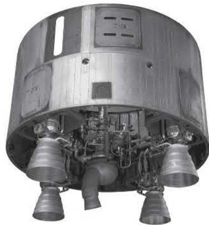
Установка рульового двигуна РД863 на кишені відсіку першої ступені МБР МР-УР100
